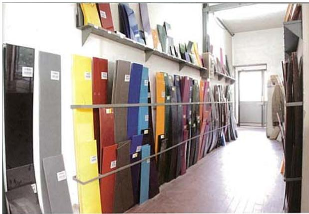
上ノ入り口には、マツケリとラエスのアセテート素材がズラリ。べっ甲時代のデザインや風合いが、アセテートにも活かされている点がこのファクトリーの魅力だ。右ノ2階が組立&検品スペース、1階がパーツの成型&加工スペース。下ノ旋盤のプログラムなど最新鋭工作機械の扱いは息子レオ氏の守備範囲。メタルバーの注入や成型した部品の研磨もすべて自社内で行う。
